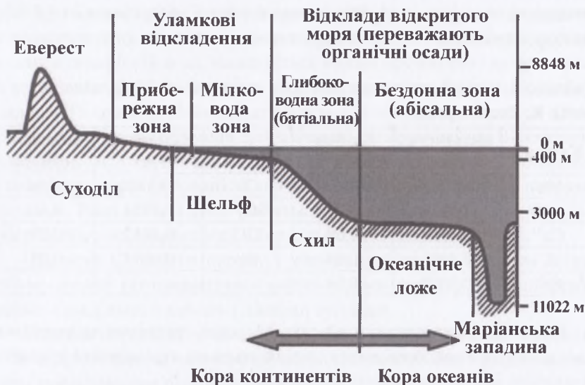
Рис. 69. Зони відкладення морських осадів та їх співвідношення із зонами рельєфу дна Світового океану
