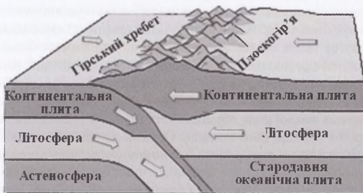
Рис. 37. Утворення гірського хребта при зіткненні двох континентальних плит
