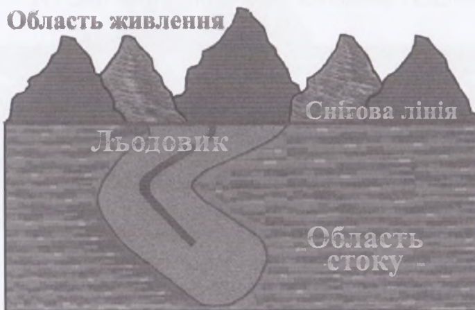
Рис. 78. Схема розташування області живлення і стоку льодовика
