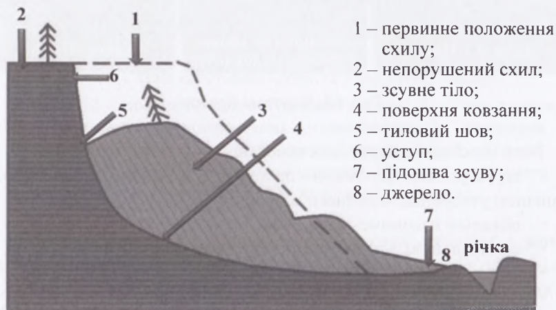
Рис. 65. Схема зсувного схилу
