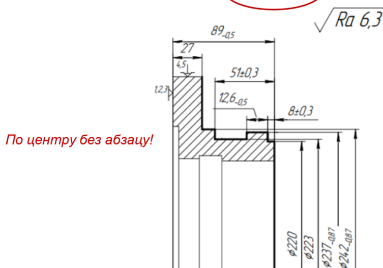
Рисунок 6.5 – Ескіз операції «025 Токарна з ЧПК»
