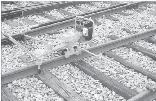
*Рис. 4.17. Ручний гідравлічний моторний шуруповерт*
