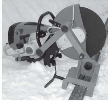
**Рис 4.6. Рейкорізнiй верстат із двигуном фірми STIHL**
