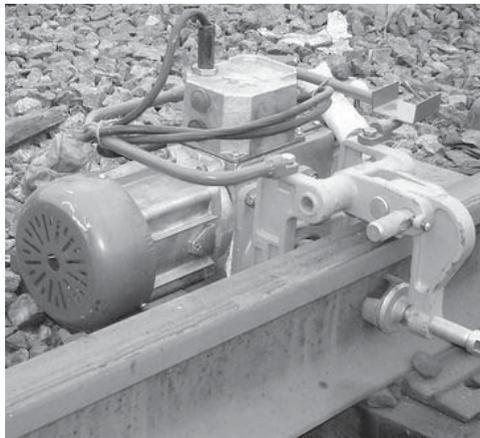
*Рис. 4.9. Рейкосвердлильний верстат СТР-2*
