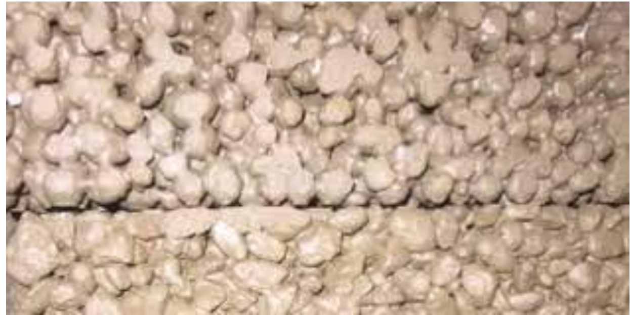
Рис. 1. Схема структури крупнопористого бетону 1 – шар цементного тіста; 2 – поровий простір; 3 – заповнювач
