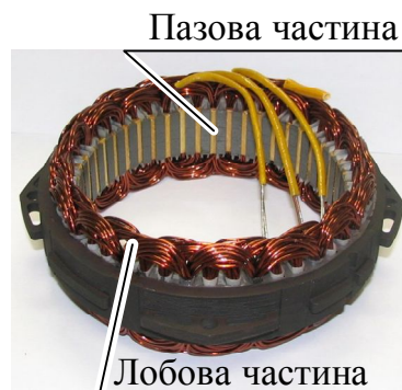
Рисунок 3.1 – Статор машини змінного струму з обмоткою
