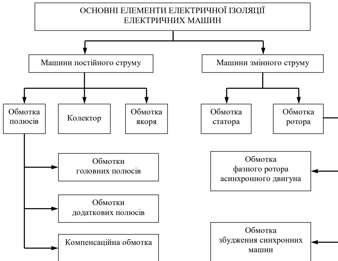
Рис. 3.1. Основні елементи електричної ізоляції електричних машин
