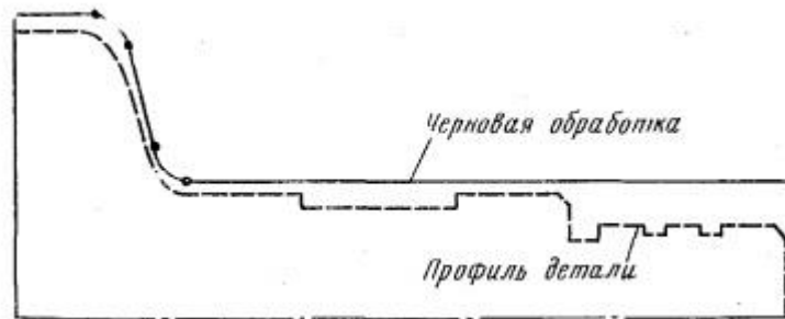
Мал.15 - Профіль деталі і заготівки після чорнкової обробки
