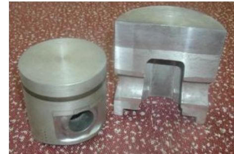
Рис. Лита заготовка поршня
