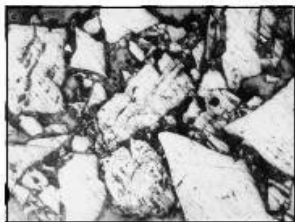
Фрагмент вуглемасляного агломерату, \times 125 : білі зерна — вугільні частинки; темна речовина — масляновугільна суміш.
