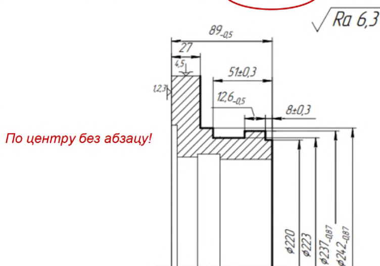
Рисунок 6.5 – Ескіз операції «025 Токарна з ЧПК»
