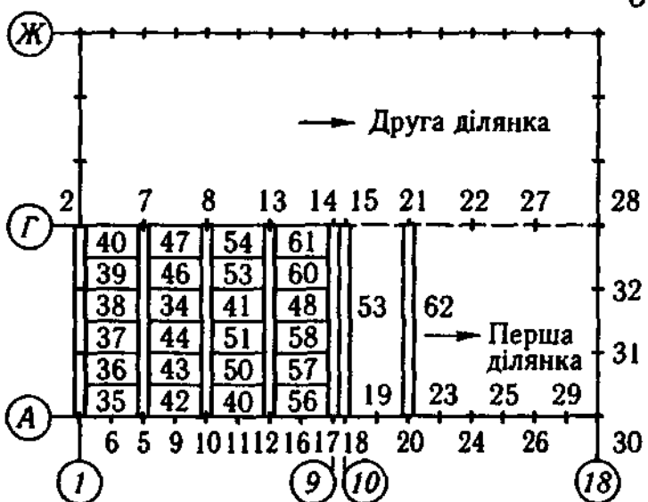
Мал. 11.5. Схеми та циклограми виконання робіт, пов'язаних з установленням конструкцій:
