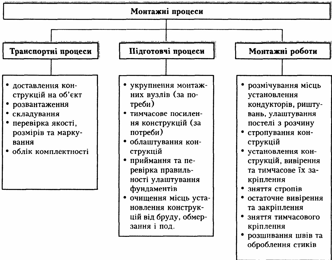
Мал. 11.1 Структура комплексного процесу монтажу будівельних конструкцій
