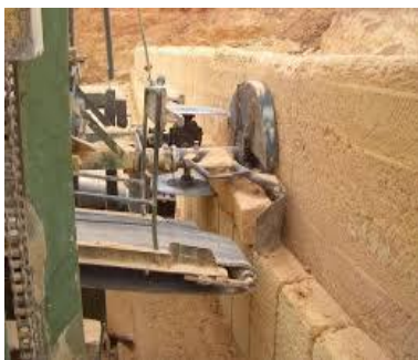
Рис.3.5.1. Каменерізальні машини з твердосплавними дисками.
