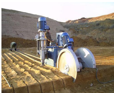
Рис.3.5.1. Каменерізальні машини з твердосплавними дисками.
