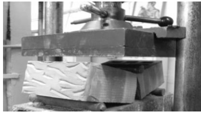
Рис. 5.10.4. Випробування цегли на згин.
