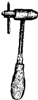
Рис.7.3. Еталонний молоток конструкції К.П.Кашкарова
