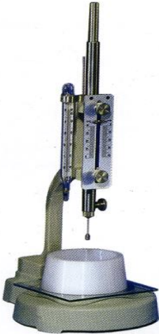
Рис.6.1. Пристрій Віка для визначення строків тужавіння гіпсового тіста
