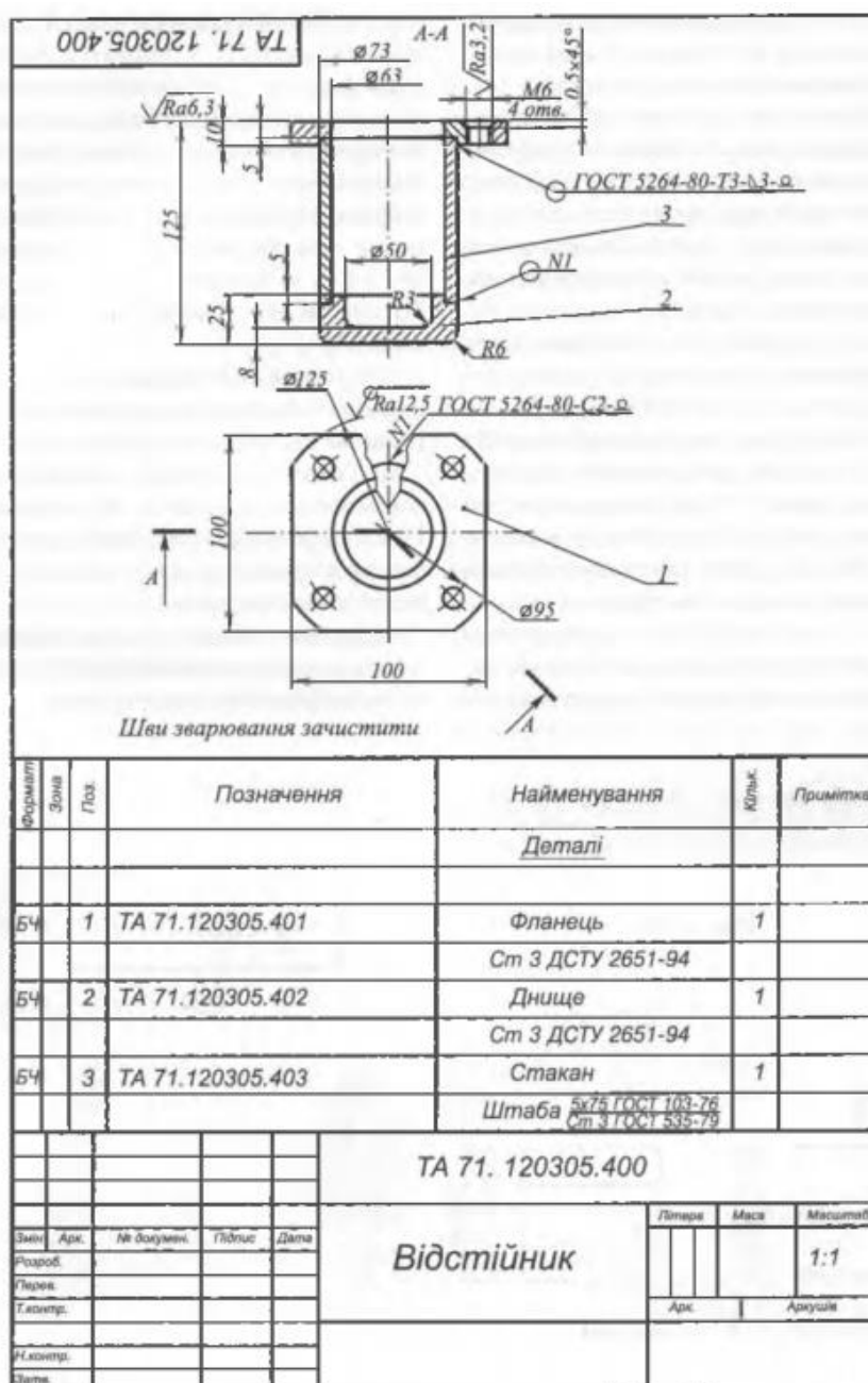
Рисунок 6 – Креслення виробу, виконане зварюванням
