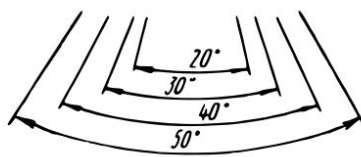
Рис. 28 - Розміщення розмірних чисел кутових
