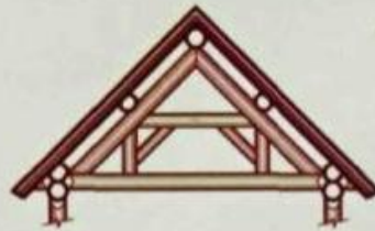
Стропильная система с укороченными стойками-подвесками
