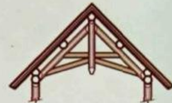
Усиленная перекрестная конструкция с центральной подвеской
